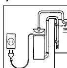
**Bij gebruik van een losse contactdoos dient deze boven de filter-aansluitkabel geplaatst te worden.**
