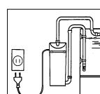
pénètre dans la prise. En utilisant par exemple une multiprise, celle-ci doit être placée plus haut que la prise de secteur du filtre.
