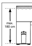
**Ten behoeve van een optimale bedrijfszekerheid mag de hoogte tussen wateroppervlak en filterbodem maximaal 180 cm bedragen.**
