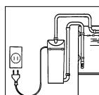
Eğer bir uzatma kablosu kullanılmışsa filrenin ana bağlantısının üstünde bir seviyede olması gerekmektedir.
